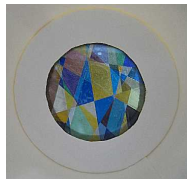
プラ板にセロハンテープを様々な方向に幾重にも貼っている
